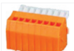
DG241-2.5 VDE 130V/6A 0.2-0.5mm 2 UL 150V/5A 28-20AWG Pola/Poles 1P-XXP
