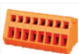
DG240W-2.54 VDE 130V/6A 0.2-0.5mm 2 UL 150V/4A 28-20AWG Pola/Poles 1P-XXP
