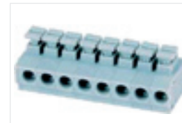
DG235-5.0 DG235-5.08 VDE 450V/15A 0.2-2.5 SOL 0.2-1.5 STR UL 300V/5A 20-18AWG Pola/Poles 1P-XXP
