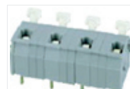
DG242V-10.0 VDE 1000V/17A 0.2-2.5mm 2 UL 300V/15A 28-12AWG Pola/Poles 1P-XXP
