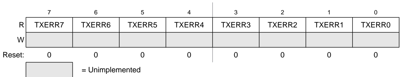
Figure 10-19. MSCAN Transmit Error Counter (CANTXERR)
