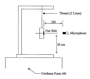
1 METER FROM MICROPHONE TO FAN INTAKE
