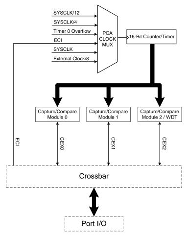
Figure 1.11. PCA Block Diagram
