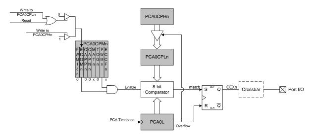
Figure 23.8. PCA 8-Bit PWM Mode Diagram
