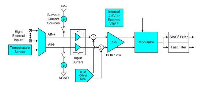
Figure 1.7. ADC0 Block Diagram
