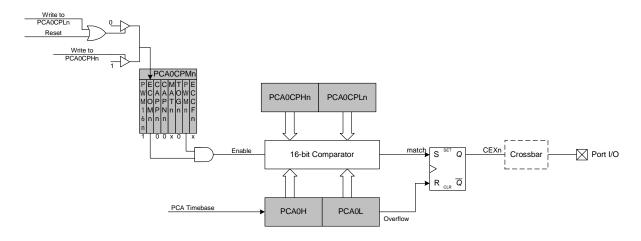
Figure 23.9. PCA 16-Bit PWM Mode
