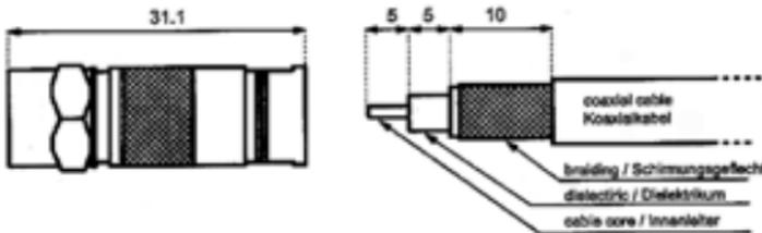
1. Isolieren Sie das Kabel so ab, dass ca. 5-10 mm Kabelseele herausschaut, ca. 5-10 mm Dielektrikum blank liegt und ca. 10 mm Schirmung sichtbar sind.
